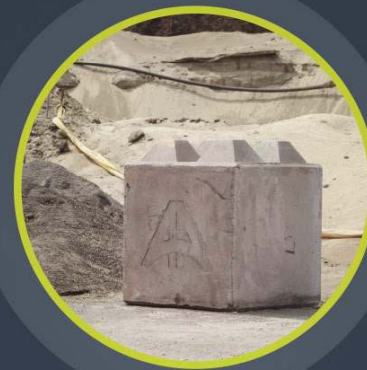
Moldeado para prefabricados de ecogravilla
