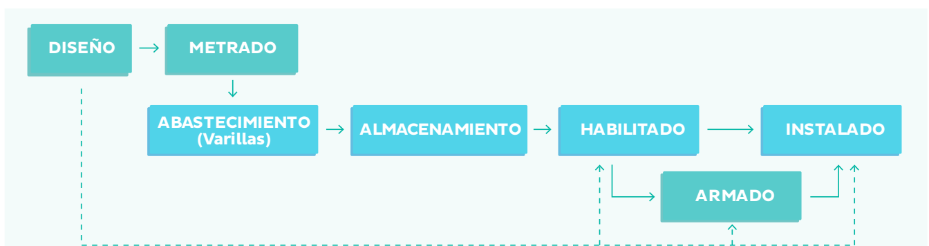
Figura 3. Proceso Tradicional de colocación de acero de refuerzo.
