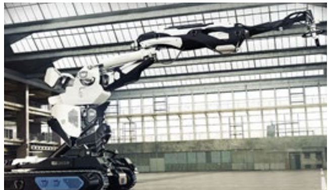
Figura 6. Impresora tipo brazo robótico ( www.3dnatives.com consultado el 12/09/2018).
