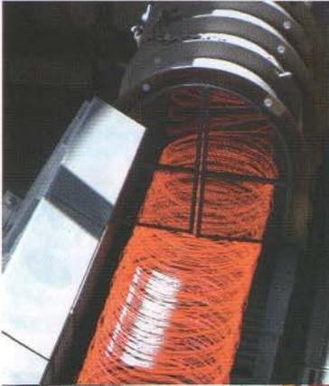
De igual manera en la Planta de Laminación (donde se lamina la palanquilla en caliente y se forma el producto final) se modernizó el Tren de Alambrones con tecnología de punta. Lo que nos ha permitido incrementar la velocidad de producción de alambrones de 15 a 60 toneladas por hora, además de poder producir una mayor gama de productos.
