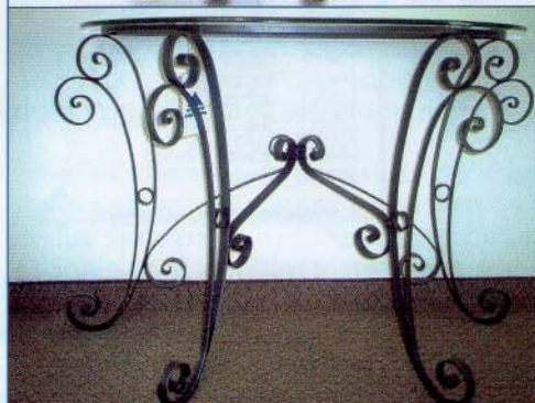
Vinera y Consola desarrolladas en las Jornadas de Cerrajería. Acabados en cobreado y zincado electrolítico
