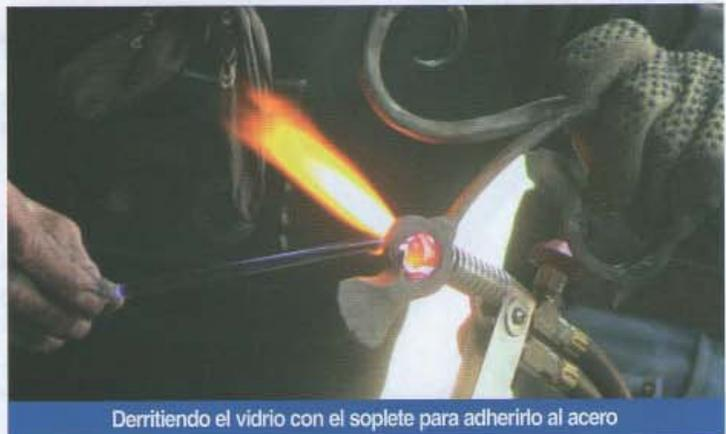
Derretiendo el vidrio con el soplete para adherirlo al acero
